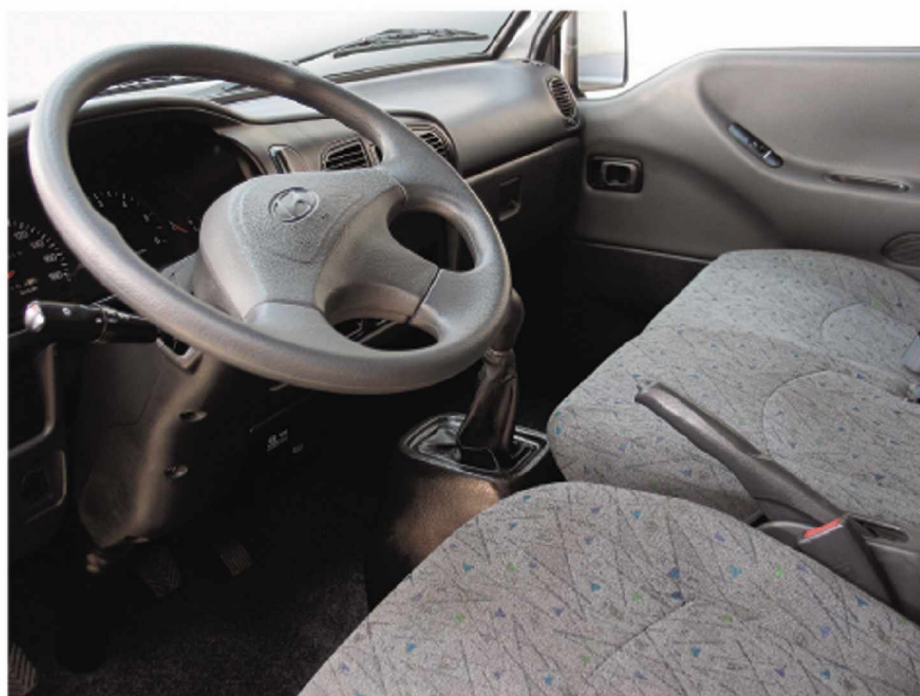
Организация водительского места призвана свести к минимуму отвлечение от дороги, что облегчает управление и повышает безопасность. Многочисленные воздуховоды обеспечивают равномерные, эффективные обогрев и вентиляцию салона
