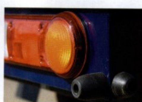
Резиновые демпферы предохраняют задние фонари от повреждений при открытии заднего борта кузова.
