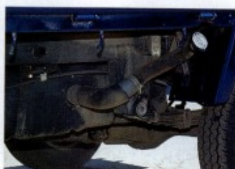
Топливный бак, рассчитанный на 60 л, расположен между лонжеронами рамы.
